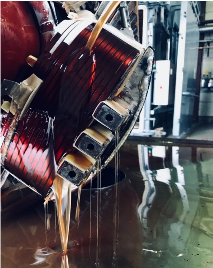
Tränkvorgang (träufeln) eines Polrades mit Harz der Iso-Klasse H
