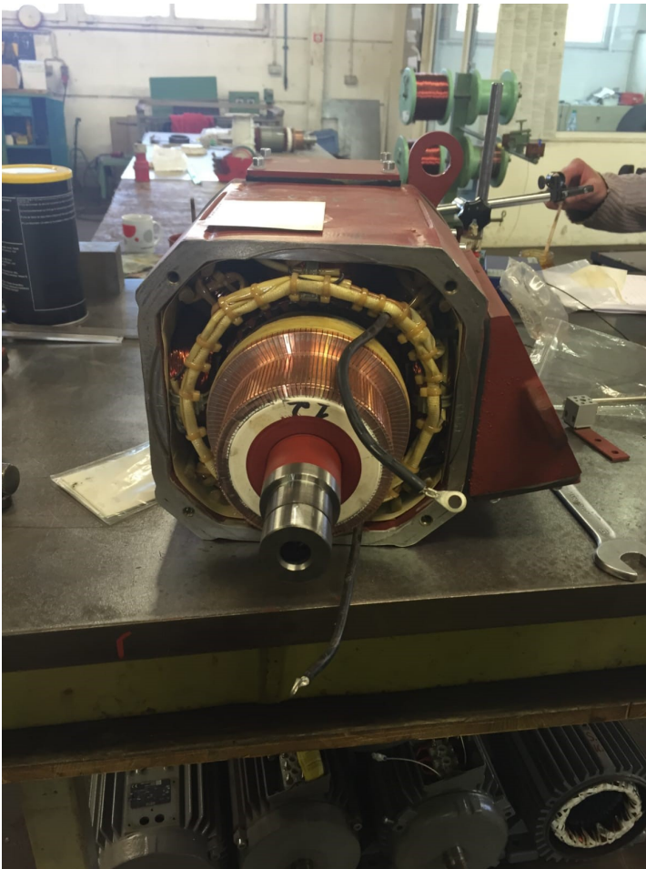
Neufertigung einer Serie von Gleichstromantrieben
